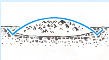
Topptäckning av deponier och inkapsling förorenade markområden.
