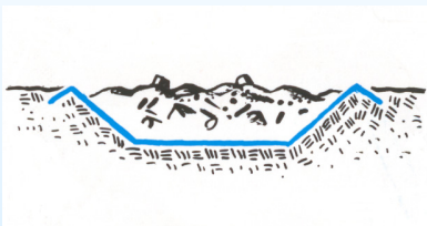
Bottentätning av t.ex. deponier.
