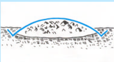
Topptäckning av deponier och inkapsling förorenade mark- områden.
